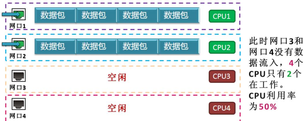
AMP+架构对此进行了优化，CPU 不再与网口进行绑定，而是将网卡的收发包队列根据数据平面的 CPU 个数平均分配到每个 CPU 上，这样就保证了数据平面 CPU 的并行度，实现了 CPU 利用率的最大化。
